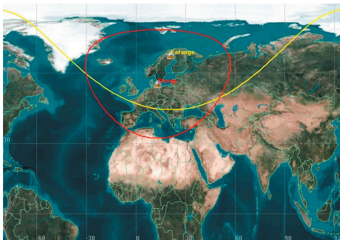
Figur 56: Esranges och Sturups täckningsområden för SPOT 5. Linjerna visar 5 graders elevation, d.v.s. det maximala område som kan täckas av en SPOT 5 när den befinner sig 5 grader över horisonten eller högre. (Bilden producerad i STK av Jörgen Hartnor, Lantmäteriet)
