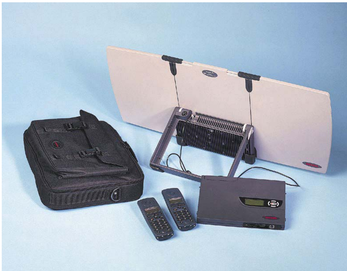
Figur 8: Bilden visar en bärbar satellittelefonutrustning för INMARSAT 30 . Utrustningen innehåller två handhållna telefoner, en dator samt en ihopfällbar antenn (den vita plattan).
